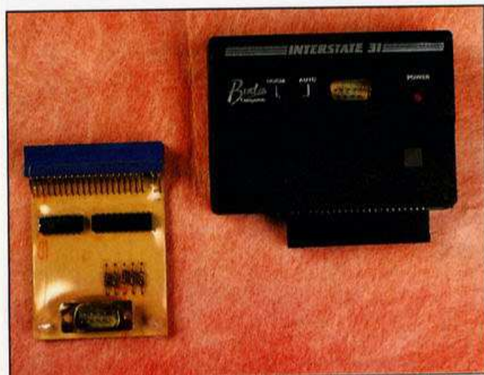
Eigenbau- und Billig-Interface nach Kempston-Norm
